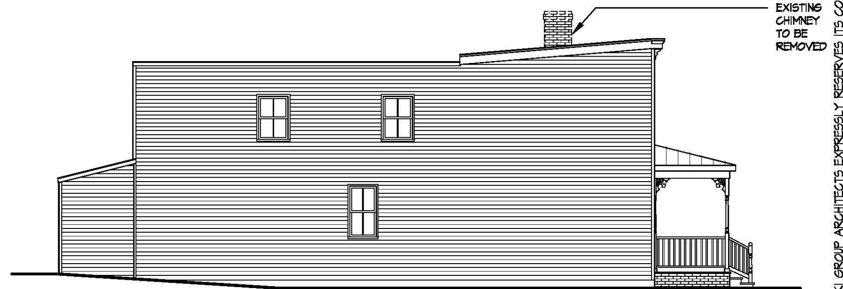
4 NORTH DEMOLITION ELEVATION A6 SCALE: 1/8" = 1'-0"
