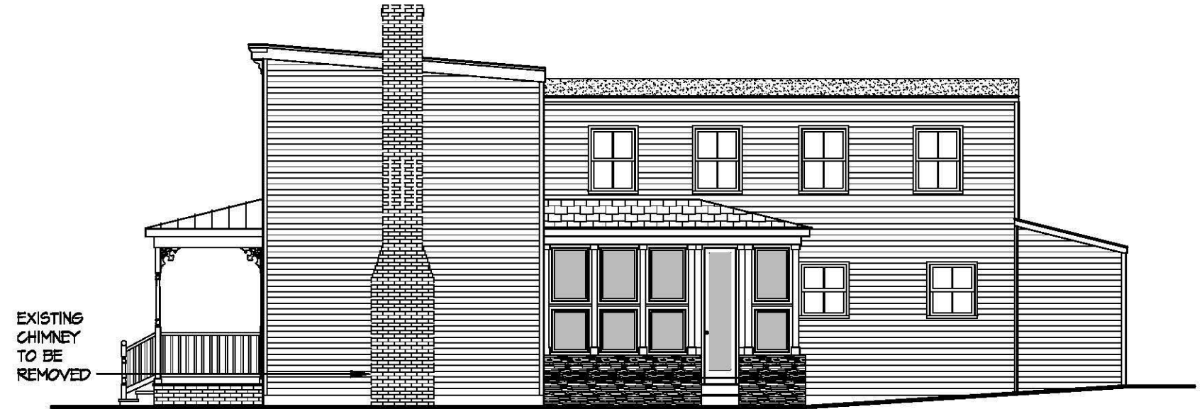
2 SOUTH DEMOLITION ELEVATION A6 SCALE: 1/8" = 1'-0"
